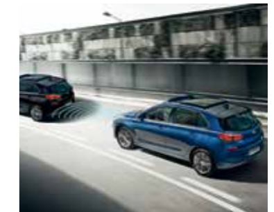
Напредната интелегентна круз контрола (Advanced Smart Cruise Control (ASCC)) овозможува одржување на растојанието со возилата што се напред, автоматски намалувајќи ја или зголемувајќи ја брзината, според потребата.
