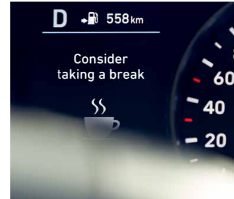
Системот за привлекување на внимание на возачот (Driver Attention Alert (DAA)) го детектира моментот кога возачот е изморен и го предупредува и со звучен и со визуелен сигнал.
