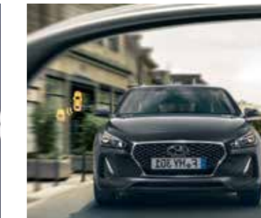
Детектирање на мртва точка (Blind-Spot Detection (BSD)) предупредува на присуство на возила што се наоѓаат во мртва точка преку звучни и визуелни сигнали.
